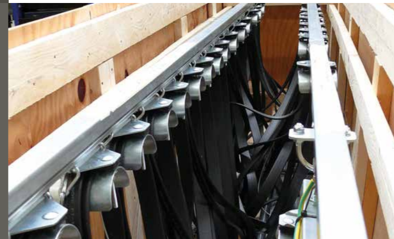
Alimentazione del carrello del paranco precabata
