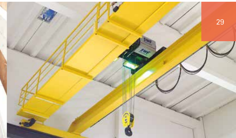
Carro ponte bitrave con luci EX su carrello
