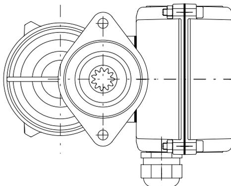
Il meccanismo direzionale deve essere montato in modo che la cassetta elettrica che si trova sul lato del motore e i cavi di collegamento siano rivolti verso il basso (vedere illustrazione qui sopra).
